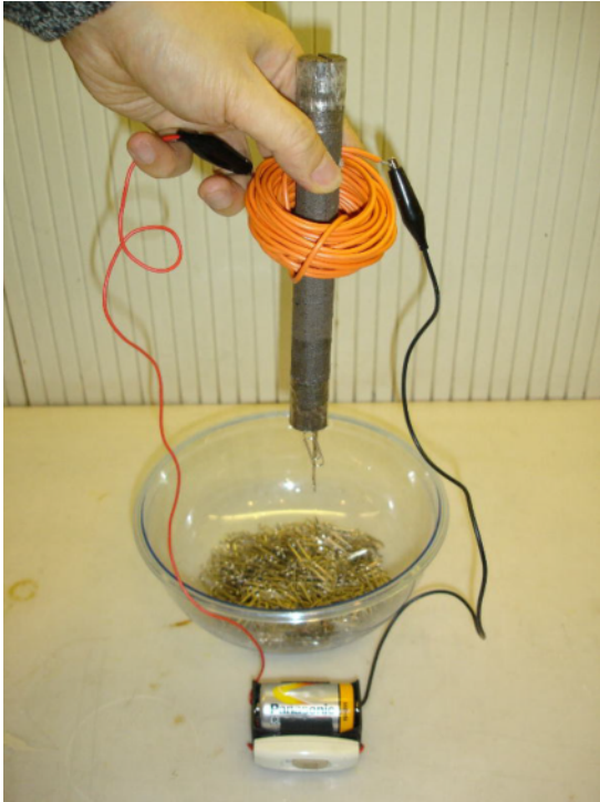
写真2 鉄芯を入れたコイルにつくクリップ
