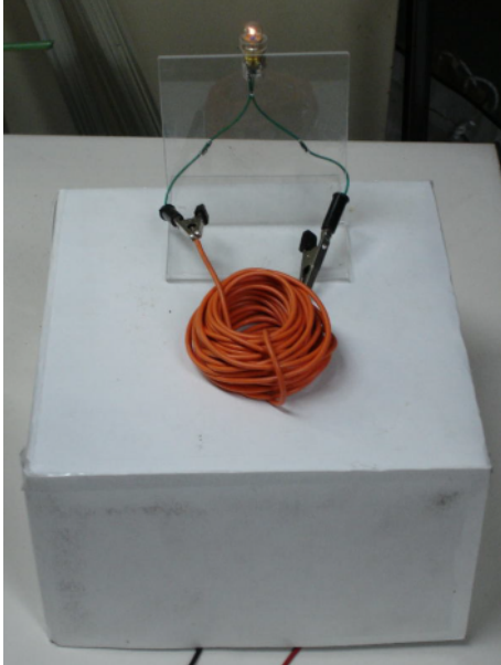
写真6 コイルにつなぐだけで点灯した豆電球
