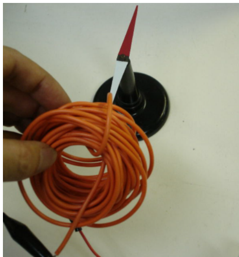
写真1 コイルの近くで向きが変わる方位磁石
