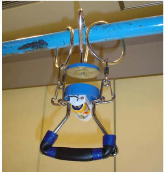
写真4 電磁石に取り付けた落下防止装置
