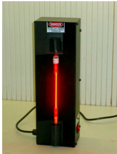
写真5. 電源一体型スペクトル管支持台
