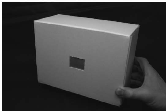
写真4-1. ほぼ完成状態のピンホールカメラ
