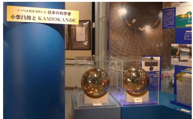
写真6. KAMIOKANDEの光電子増倍管
