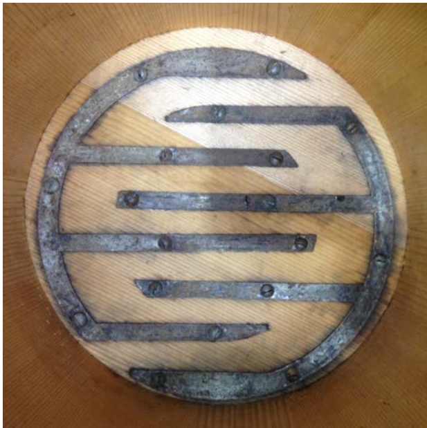
写真2.「たからおはち」内部の電極
