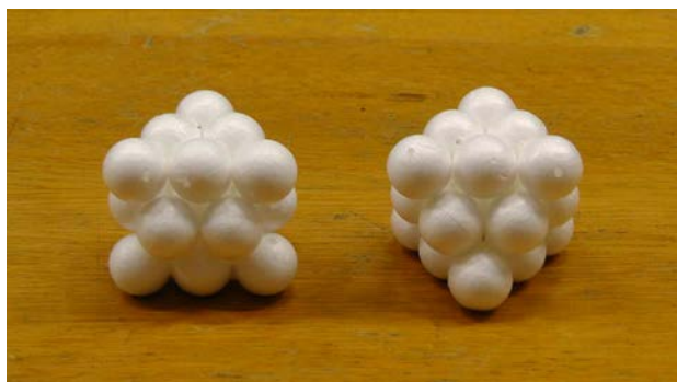
写真7. 六方稠密(左)と面心立方の八面体(右) (同じ部品の重ね方で構造が異なる)
