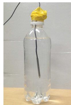
写真2. ペットボトルに入れた温度センサー
