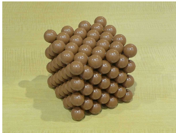
写真8. 鉄(γ-Fe)の結晶模型 面心立方格子の場合は、きれいな立方体にしやすい
