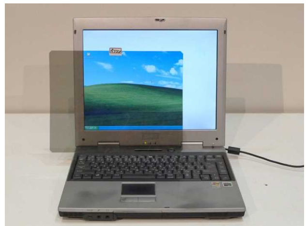
写真9. 偏光板を剥がしたノートパソコン
