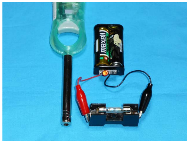
写真25. 現代のコヒーラを用いた実験
