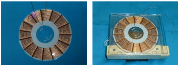
写真17. スパイダーコイル完成品と基盤へ取り付け
