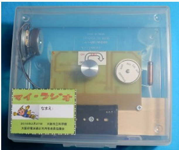
写真12. ラジオ基盤をケースに収め、組立て完了
