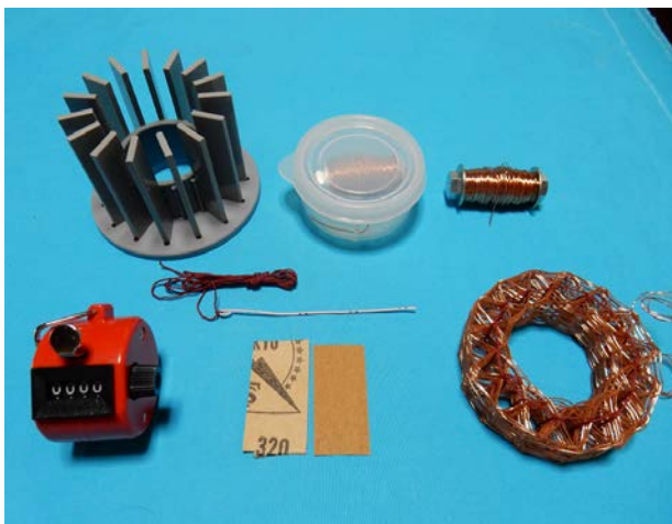
写真13. バスケットコイル用器材 (巻枠、ポリウレタン線他)
