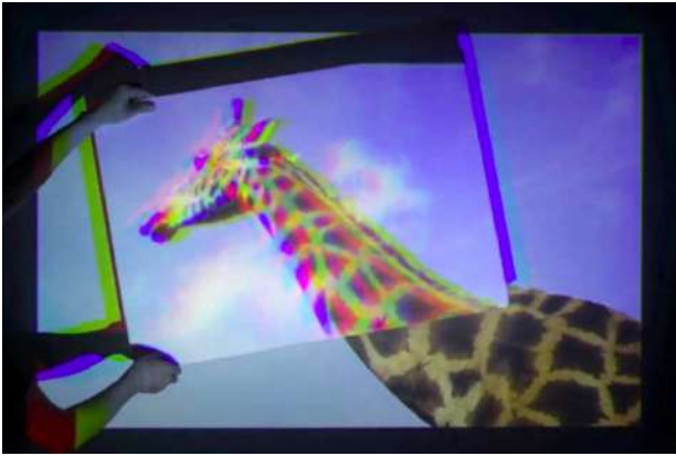
写真6. プロジェクター3台を使ったカラー画像の合成
