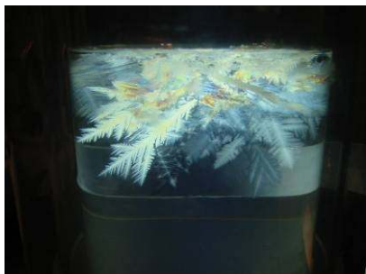
写真1. 過冷却水による氷の成長偏光板を通しての観察。
