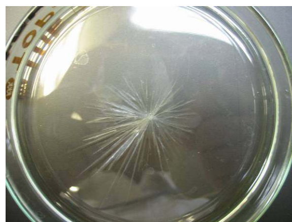
写真 5. 酢酸ナトリウムの結晶をシャーレ中央に置くと、放射状に結晶成長が始まる。
