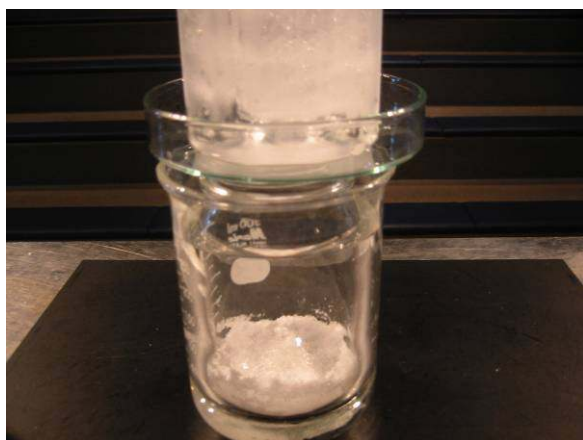
写真 2. パラジクロロベンゼンを湯せんしているところ。上部は、シャーレでフタをし、凍らせたペットボトルを載せることで、結晶が析出しやすくしている。
