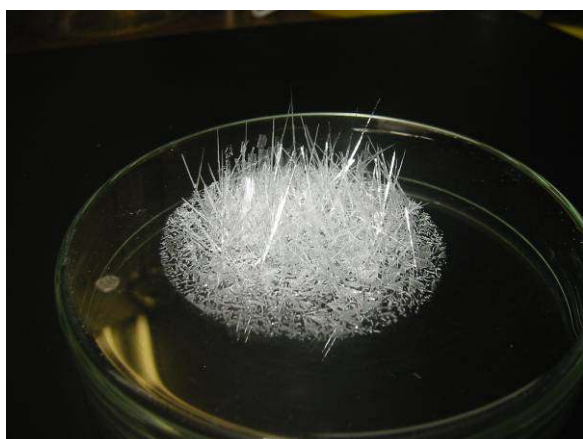
写真 3. 析出したパラジクロロベンゼンの結晶。写真 2 の状態で約 10 分程度で、このような状態になる。
