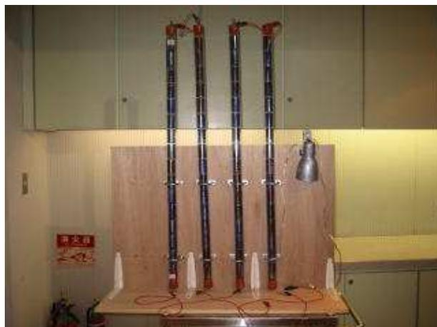
写真3. 96V電池の実験装置。この台には7本までアクリルパイプを立てられる。最大112個まで電池をセットすることができる。
