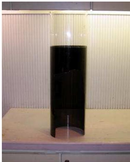
写真4. アクリルパイプに紫外線カットフィルムを巻いたもの。可視光透過率は5%のもの。
