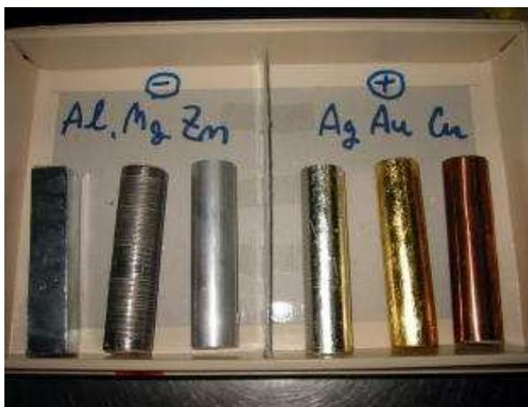
写真2. ニギルト電池の電極
