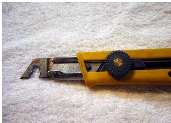
写真5. 融けたカッターの刃。焼き切ることもできるが、刃の間を大きくえぐり、刃の状態がどうなっているのかを見せることが多かった。なお、カッターの刃であるため、融かした部分は、折って捨てることができ、次の部分がすぐ実験できるようになる。
