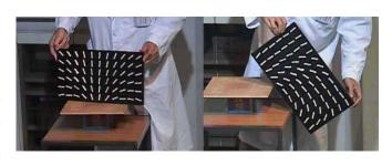
常に簡単である.上図はストロー片が大型ネオジム磁石1の磁力線を描いた様子である.磁力線の乱れを避けるために,鉄釘でなく銅釘を使用している.また,ゼムクリップの自由度は回転だけなので,重力の影響を受けずに磁力線が鮮明に描かれる.
