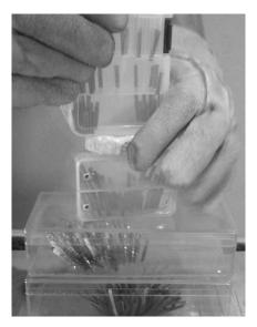
線を可視化する . たとえば , LED を結線したコイル ( 23000 巻き ) と大型ネオジム磁石と を相対的に動かし , そのときの磁力線の様子と LED の点灯とを同時に観察することで , 磁力線がコイルを切ると起電力が生じることを視覚的に理解させることができる .
