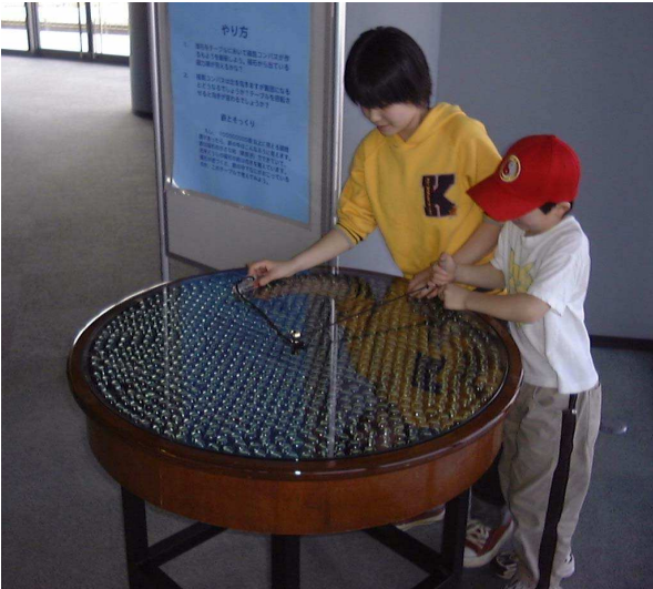
図7 展示場で公開した展示装置. 方位磁石 1000 個をターンテーブルに敷き詰めたもの. 全体を回転させることで、磁区が地磁気に影響されないことが分かる.
