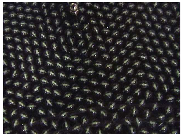
図6 磁石で磁区を乱した不安定な状態(上)から、数秒で磁区が形成される(下)。
