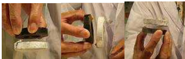
図9．高温超伝導体をネオジム磁石の下方近傍で冷却すると、これらの相対的な位置が固定される。ネオジム磁石を持ち上げても(左)、横向きにしても(中)、裏返しても(右)超伝導体とネオジム磁石の相対的な位置は変化しない。
