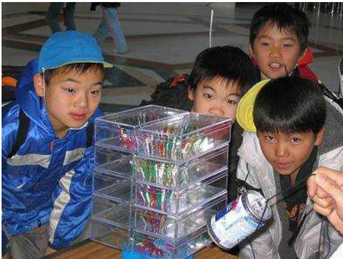
図3. ビニールタイで見る大型ネオジム磁石の磁力線。アクリルケースで空間を細分し、ビニールタイの併進運動を制限することで、磁力線が大きく現れる。迫力ある磁力線の出現に見学者の興味が喚起される。
