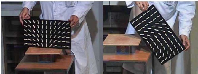
図2. ゼムクリップによる磁力線観察。ゼムクリップの運動は回転だけなので、磁力線は重力の影響を受けず鮮明に表れる。
