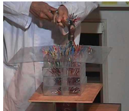
図7．金槌が磁力線を下部から吸い込み上部から湧き出す様子を見せたもの。 \operatorname{div} \mathbf{B} = 0 を表現する。込みのないことを表すもので，N極やS極が単体では存在しないことの数学的表現である。すなわち，磁力線が空間のどこかで切れることがないことを意味するもので，図7はまさに(3)式を鉄の内外で見せている。
