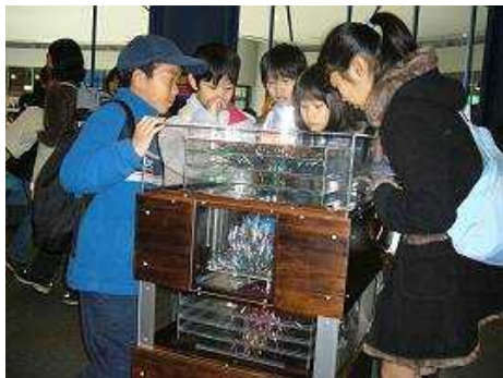
図8．磁力線観察の展示化。中心部にある大型ネオジム磁石を自由に回転させることができる。その回転に応じて、ピニールタイが磁力線を3次元的に描く。見学者はこの動きに夢中になり、無意識のうちに磁場を観察する。
