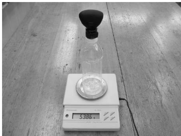
写真1 空気の重さの測定
