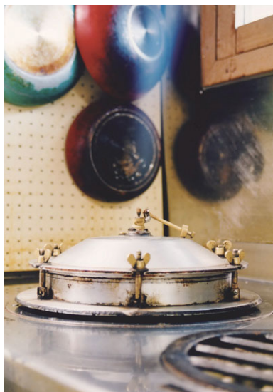
山頂では沸点が約88℃なので圧力釜で煮炊きを行う。また、ガスはなく調理器具は電気コンロを使用する。
