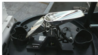
転倒ますの原理 内部の「ます」が左右に傾く
