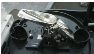
転倒ますの原理 内部の「ます」が左右に傾く
