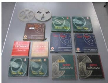
1950~60年代頃に、家庭用録音機で録音するために使用されていたテープです。リールがむき出しになっていることから、オープンリールテープと呼ばれます。幅6mmで長さが数百mもある薄いテープに、酸化鉄等の磁性体を塗布してあります。このテープを磁化することで、音声信号を記録することができました。1970年代以降、取り扱いが便利なカセットテープが使われるようになりますが、信号の記録は同じ原理を使っています。 江越 航(学芸員)
