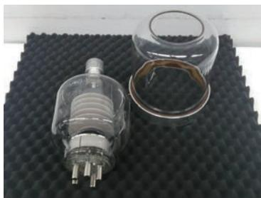
真空管は1970年代はじめ頃まで使われていた電子部品ですが、トランジスタが普及してもなお、高電圧や大出力が必要などころでは使い続けられました。この真空管は、和泉市にあった大阪航空局信太航空路監視用レーダー事務所でビーコン（誘導電波）を出すために使われていた送信管です。大出力の真空管で、冷やすためにガラス製のフードを被せ、風を送りながら使用しました。
