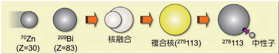
図2. 113番元素が合成される様子 ビスマス( ^{209}\text{Bi} ) 標的に亜鉛( ^{70}\text{Zn} ) ビームを照射して質量数278の113番元素( ^{278}113 )を合成した。融合した直後の複合核は励起状態にあり、中性子一つ放出して基底状態になる。 この時の原子核反応を、 ^{209}\text{Bi}({}^{70}\text{Zn}, n){}^{278}113 と表記する。
