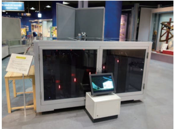
最新鋭のMWPC方式のミュオグラフィ装置。 ミュオンが通り抜けると前面のLEDが光る。
