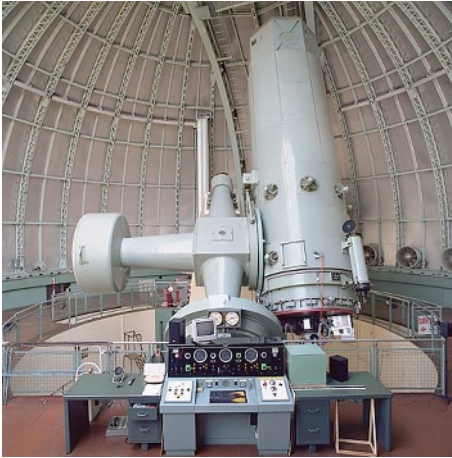
図2. マイヨールらが太陽系外惑星の発見に使ったオート・プロヴァンス天文台193cm望遠鏡、岡山の188cm望遠鏡と同じグラブ・パソソンス社製 ©Ministère de la Culture
