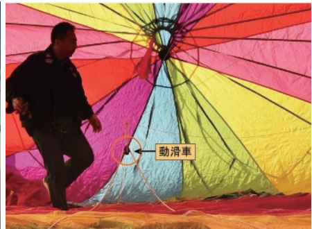
↑写真2. 熱気球についている動滑車 (立ち上げ前の球皮内点検中)
