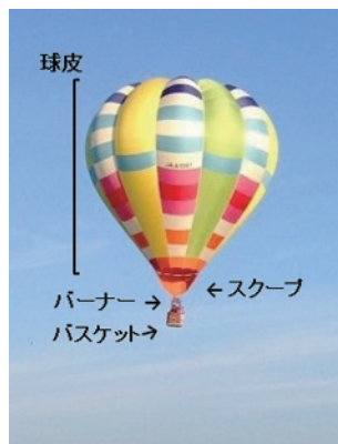
写真1. 熱気球の構造(左:熱気球全体、中:バーナーとバスケット、右:模式図)
