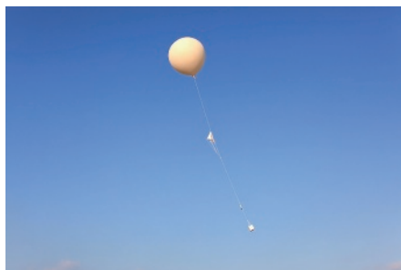
空を飛ぶラジオゾンデ 一番上に気球、中央部にパラシュート、 一番下にラジオゾンデがついている。 (高層気象台ホームページより)
