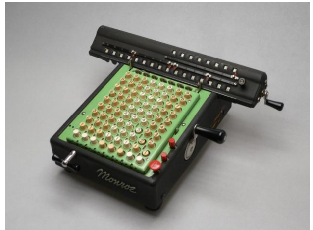
写真8. フルキーボード型手回し式機械計算機
