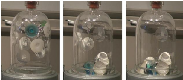
写真3. 真空にすると自然に落ちる吸盤
