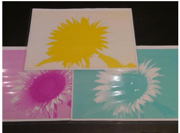
写真5. 色の三原色を別々に印刷した写真
