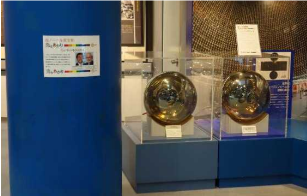
写真4. 光電子増倍管
