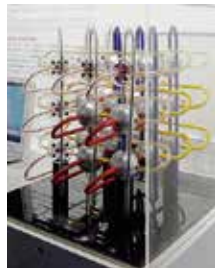
写真2. 6次元メッシュトラス構造のインターコネクトモデル
