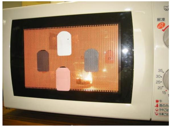
写真7. プラズマを発生させ、デンタルフィルムが感光するか確認中。
