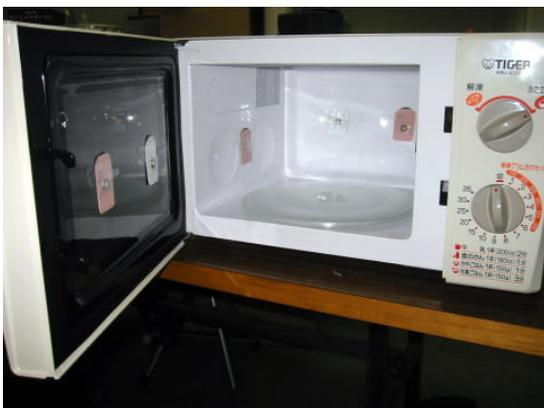
写真6. レンジ内に6箇所、扉外側に2箇所デンタルフィルムを取り付ける。
