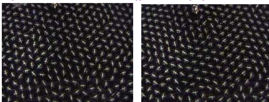
磁石でかく乱しても（左）すぐに近傍で同じ向きに揃う（右）
