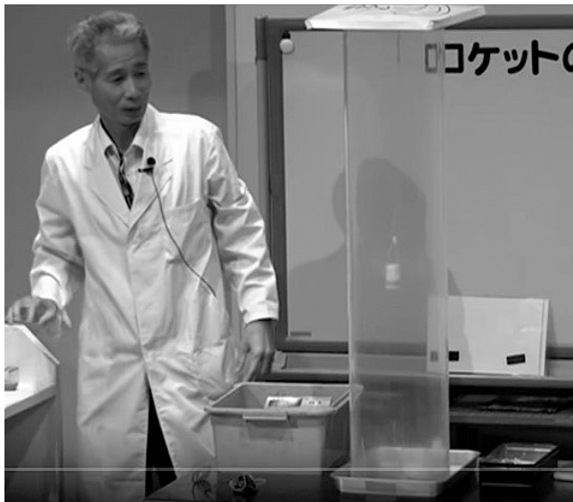
写真2 宙づりの入浴剤ロケットと著者。勢いよく飛び上がって金属板に衝突する。大音響で飛び上がったことがわかる。
