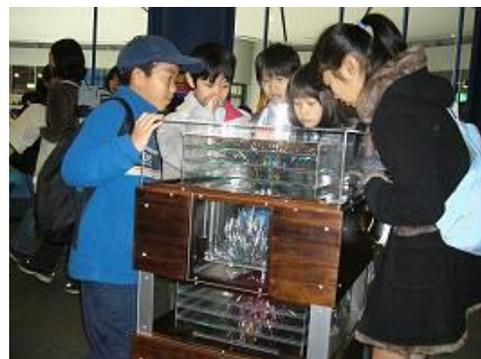
図 12. 磁力線観察の展示化。中心部にある大型ネオジム磁石を自由に回転させることができる。その回転に応じて、ビニールタイが磁力線を3次的に描く。見学者はこの動きに夢中になり、無意識のうちに磁場を観察する。
