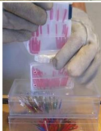
図6. マイスナー効果。超伝導体は大型ネオジウム磁石の上部にあり、その近傍の磁力線の様子をビニールタイが描いた様子。上図は超伝導体の上にアクリル板を置き、ビニールタイをばら撒いた様子。超伝導体の上部にビニールタイが位置することがなく、超伝導体から磁力線が出ていないことが分かる。下図はビニールタイを入れた多段のアクリルケースを超伝導体の上下に置いたところ。超伝導体近傍に磁力線のない事が分かる。
