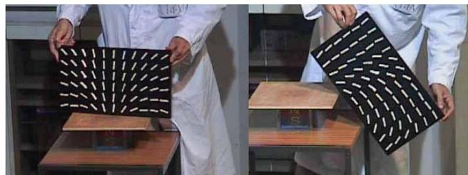
図2. ゼムクリップによる磁力線観察。ゼムクリップの運動は回転だけなので、磁力線は重力の影響を受けず鮮明に表れる。
