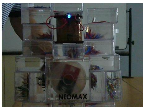
図 10. 3次元磁力線観察装置による電磁誘導の観察。ネオジム磁石が回転するとコイルに結線されたLEDが点灯する。コイル内の磁束の変化とLEDの点灯とを同時に観察させることで、電磁誘導の本質へ導くことが可能。
