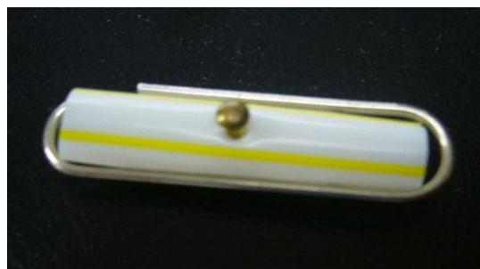
図1. ストロー片にゼムクリップを付け、自由に回転できるように銅釘で串刺しにする。
