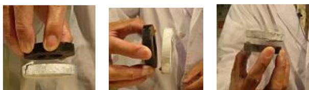
図7. 高温超伝導体を上図のようにして冷却すると、ピン止め効果により超伝導体と磁石の相対的距離が固定される（下図）。
