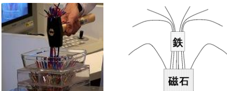
図5 鉄による磁力線の集中。写真左はハンマーの頭部とビニタイ。ビニタイの下方に10cm角のネオジウム磁石がある。ビニタイ群が鉄に集中する磁力線を見せている。右はその概念図。
