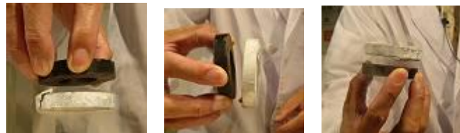
図2 超伝導体の固定。ネオジウム磁石（黒い物体）で超伝導体を吊り下げ（写真左）、続いて、ネオジウム磁石を反転させる（写真中・右）。磁石と超伝導体との相対的位置関係はほとんど変化しない。
