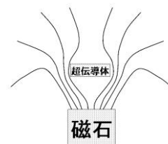
図3 磁力線の排斥。図1の超伝導体近傍の磁力線観察（左）とその概念図（右）。超伝導体の上にプラスチック板が、さらにその上にビニタイ群が置かれている。超伝導体は発泡スチロールの保冷容器に満たした液体窒素に浸けられている。保冷容器の下方には10cm角のネオジウム磁石があり、超伝導体に向かって磁力線が湧き出ている。ビニタイ群は、磁力線が超伝導体を避けていることを示している。
