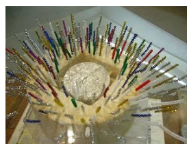
図3 磁力線の排斥。図1の超伝導体近傍の磁力線観察（左）とその概念図（右）。超伝導体の上にプラスチック板が、さらにその上にビニタイ群が置かれている。超伝導体は発泡スチロールの保冷容器に満たした液体窒素に浸けられている。保冷容器の下方には10cm角のネオジウム磁石があり、超伝導体に向かって磁力線が湧き出ている。ビニタイ群は、磁力線が超伝導体を避けていることを示している。
