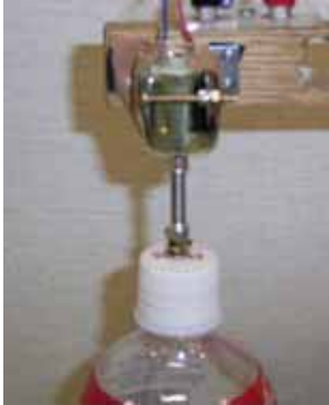
図11. マブチモータとペットボトルの接続 ペットボトルの底面中央に10mm程度の穴をあけ、台に固定した竹ひごをその穴に入れる。
