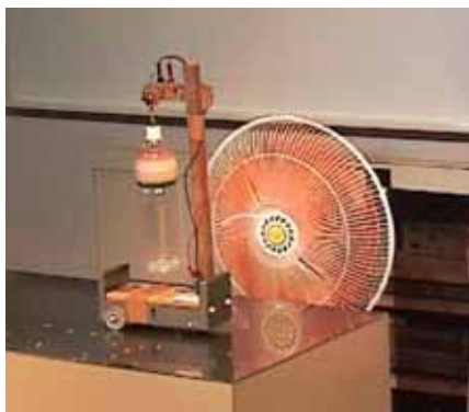
図9. 回転体に風を当てると、力学台車は風向と垂直 の向きに動く。(マグヌス効果)
