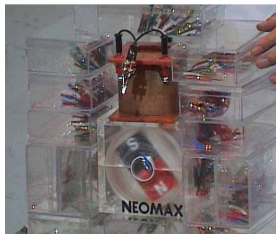
図10. 磁力線の変化で起電力の生じることを観察。
