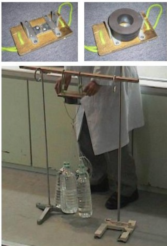
図4. 磁石に鉄枠模型を取り付けると(上)、強力になる(下)。
