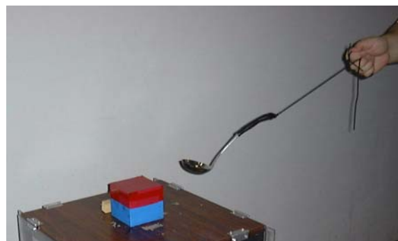
図6. 超強磁石。10cm角のネオジム磁石にお玉が引き付けられている様子。
