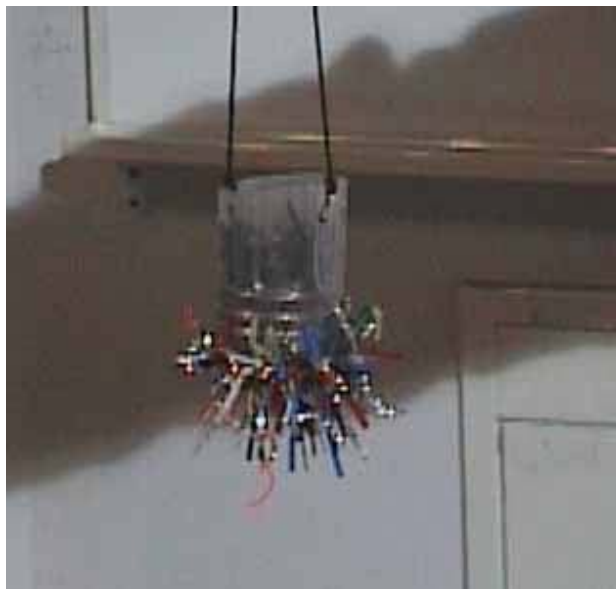
図8. 磁石粉体の着磁。ペットボトルに入れた磁石粉体は超強力磁石で磁化する。これを揺すって、各磁石粉の磁極方向をバラバラにすると消磁し、モールドは着かなくなる。
