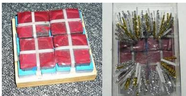
図3. 扁平磁石模型(左)とモールで見る磁力線(右)
