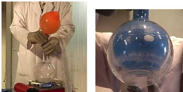
図1. 水蒸気で膨らむ風船(左)と水蒸気の液化により中に膨らんだ風船(右)。底に少量の水が溜まる。
