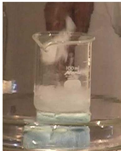
図5. 液体窒素の固化。表面で凍った固体窒素がときどき飛び上がる。
