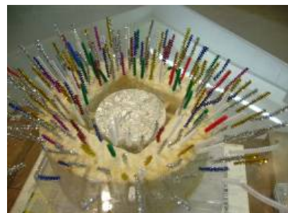
図 7. 超伝導体による磁力線の排除
