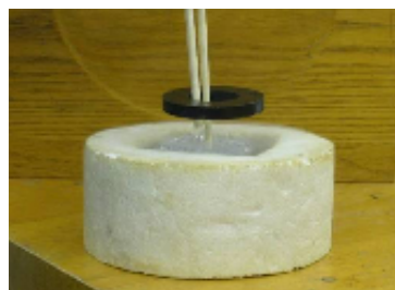
図1. 高温超伝導体がネオジム磁石を反発。
