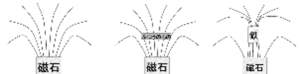
図 5. 磁力線が鉄(ハンマー)の一方に流れ込み他方から流れ出すことを示す現象と図
