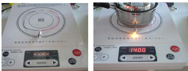
図 13 電磁調理器で電球を灯す実験。左のように結線した電球の上に金属鍋を置く。
