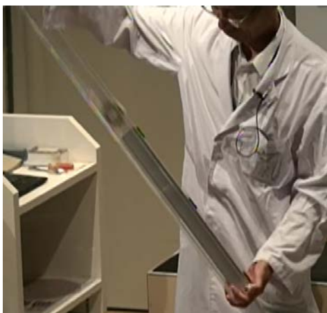
図4 ネオジム磁石がアルミ板の前で減速する
