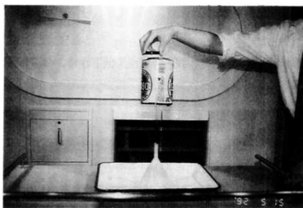
写真2. 強力磁石によりアルミ缶が回転する
