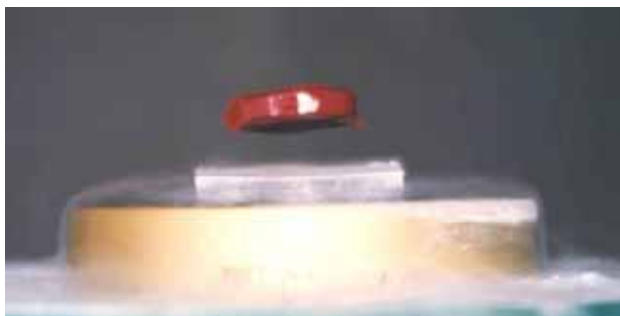
図6 . 夢のベアリング . 磁石が超伝導体の上で回転する .
