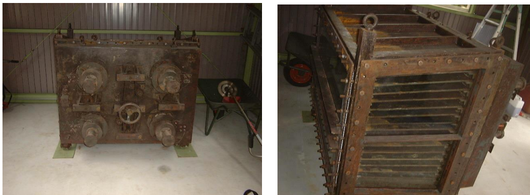
図 1. 世界最大級の霧箱。宇宙線が霧箱を貫いた瞬間に 4 つのピストン(左)で霧箱内を減圧すると、宇宙線が飛んだ跡に、飛行機雲ができるようにアルコールの雲が発生する。高さ:125、横幅:132、奥行き:73(cm)。
