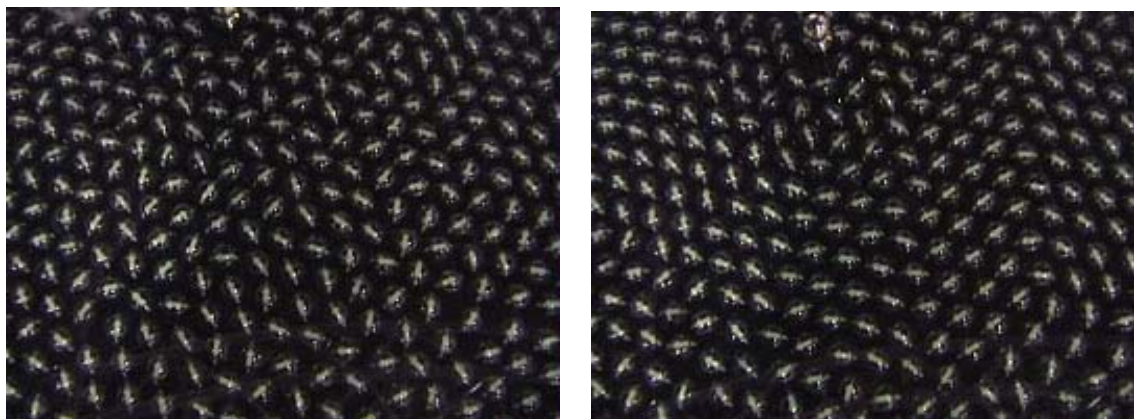
図 10. 方位磁石結晶を磁石で攪乱したところ（左）。右はその後現れた磁区構造。
