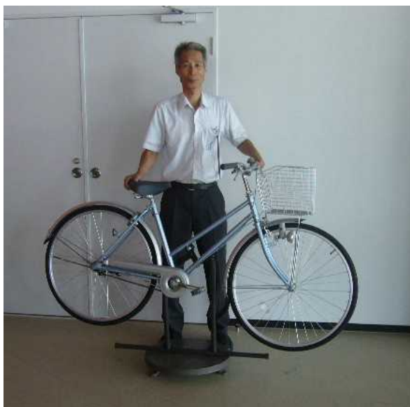
図2 . 自転車の安定性を実証しようとした実験装置。車輪を高速回転させ、支えている手を離すと？
