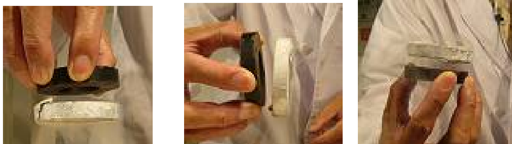
図4. 高温超伝導材の上方に磁石を置いて冷却すると、縦横に関係なく、高温超伝導材と磁石とが冷却前の間隔を保とうとする。
