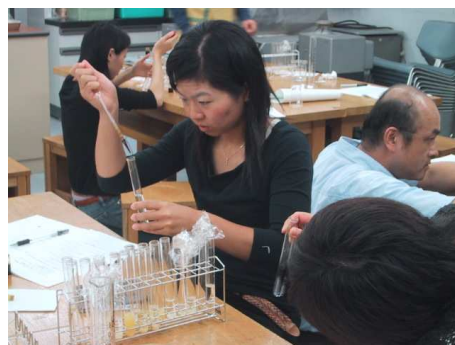
写真1. 本来ビュレットを使えば正確に測定できるが、初心者向きに、スポイトで滴数を数えれば、精度は落ちるが簡易に定量できる。
