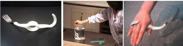
写真3. (左)病気や怪我で握る力の弱い人でも使いやすい商品「ウィル・ツー」、(中)約80度の湯で温めてやわらかくし、(右)自分の手のサイズに合わせて曲げて冷やし固める。握らなくても手にひっかけて使うことが可能
