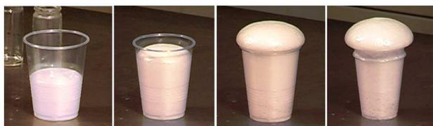
写真9. 混ぜるとすぐに膨らみ始め、約30秒で(右)ほどの大きさになり反応が終了する
