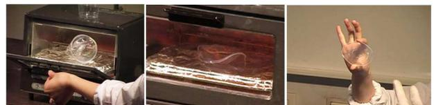
写真6. (左)上部の電熱部に直接コップが触れないよう横に倒して置く、(中)約15秒加熱する、(右)楕円形に変形する
