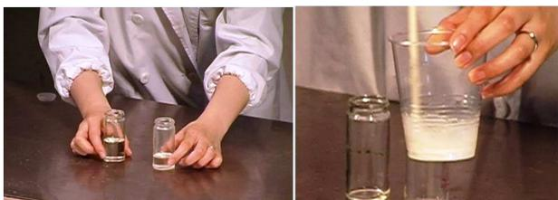
写真8. (左)反応前のポリオール(向かって左)とイソシアネート、(右)割り箸でかき混ぜると白く変化し始める
