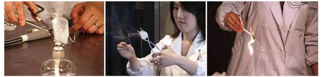
写真4. (左)溶け始めて透明になる、(中)ピンセットで溶けた部分を摘んで引っ張る、(右)ストローは、燃えながら融解して落ちる。下にひいたアルミホイルの上でも、しばらく燃え続けることもある
