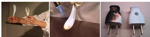
写真7. (左)プラスチック製(向かって左)と陶器製、叩いて音を出すと違いがよくわかる、(中)加熱すると焦げる、(右)加熱して焦げたプラグ、「ピザのチーズ」タイプに対して、「ピザの土台のパン」(焼くほど焦げる)タイプと表現
