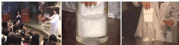
写真 11. (左) 何から採った油かをにおいで当ててもらい、(中) 発泡スチロールを浸すと間もなく空気の泡がたくさん出てくる、(右) 発泡スチロールは溶けた
