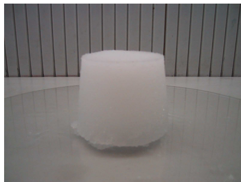
写真9. 水を吸収した高分子吸収剤(プリンのように逆さにして型からだしたもの)
